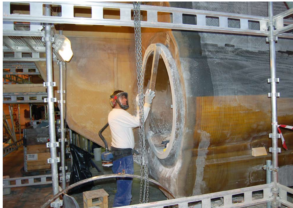
Den komplekse og varierende sammensetningen av komposittmaterialer gjør gjenvinningsprosessen vanskelig, men samtidig ligger det en verdi i alle komponentene. Bildet viser utløpet av en vannjet på en av Forsvarets nye MTB-er. Foto: Ragnar Brekke
