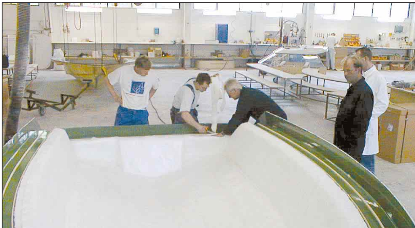
Utvecklingsarbete på Rydsfabriken. Till vänster ses Lars Lindqvist, projektledare för den nya tekniken på Ryds. Den torra armeringen görs i ordning för att injiceras under ett vakuumtätt skal.
