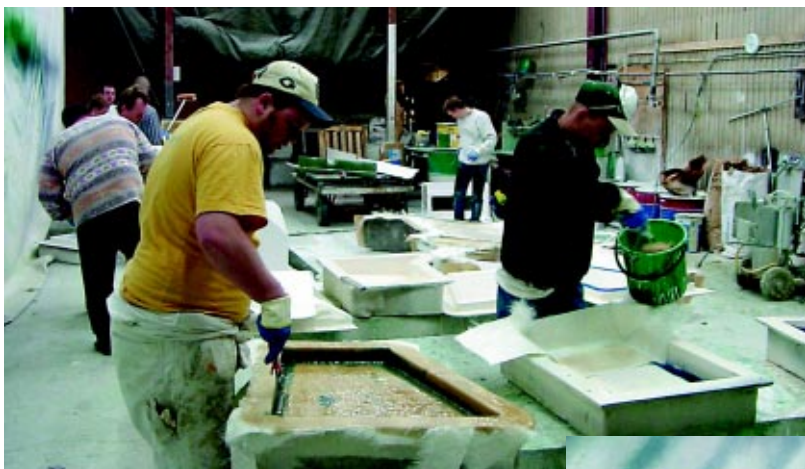
Allmän tillverkning av praktikedetaljer med enkel handlaminering hos Sjöberg plugg och form AB i Lysekil.
