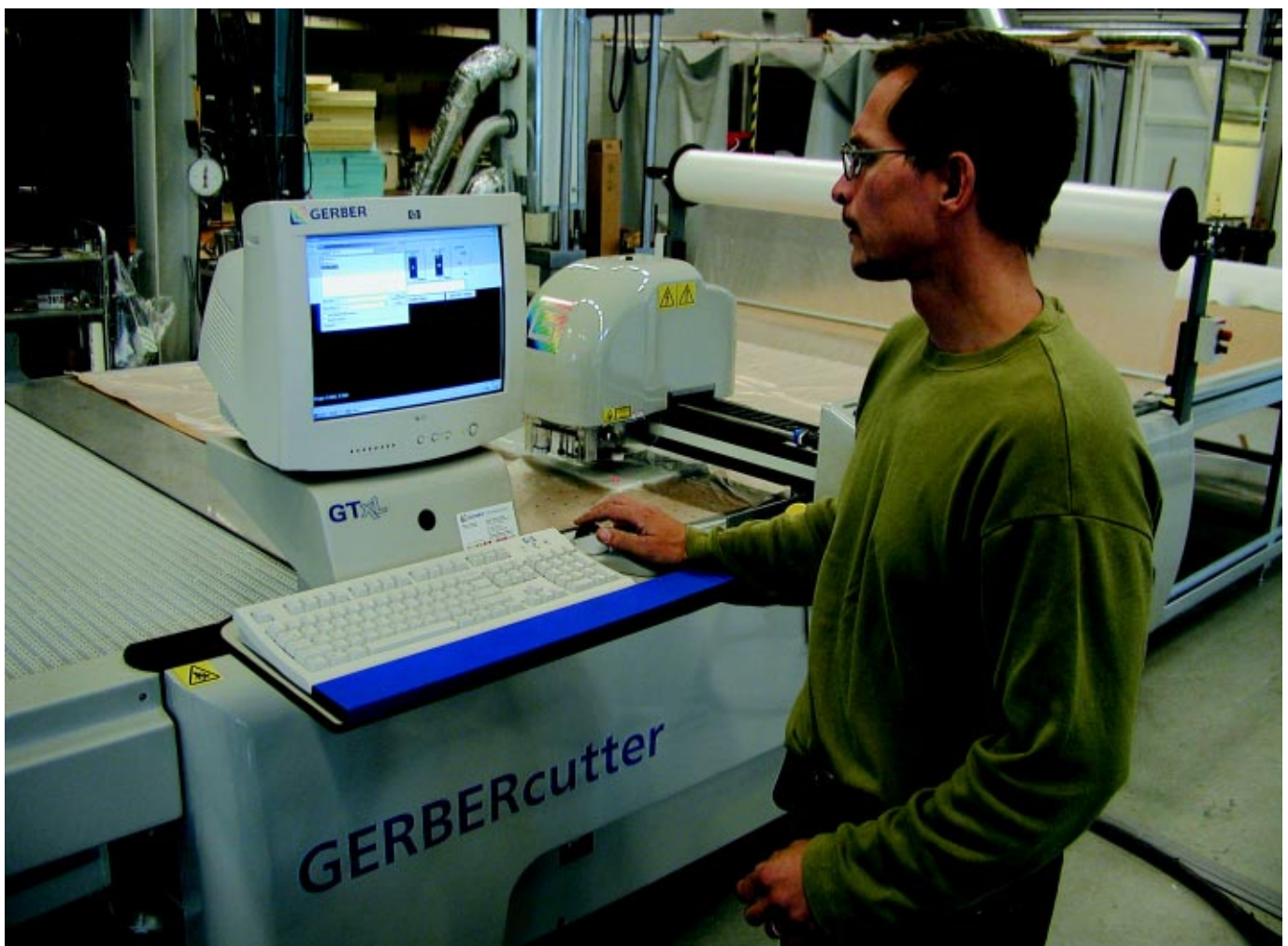
Nyinstallerad skärmaskin på SICOMP för rationell konfektionering av armeringsmaterial.
