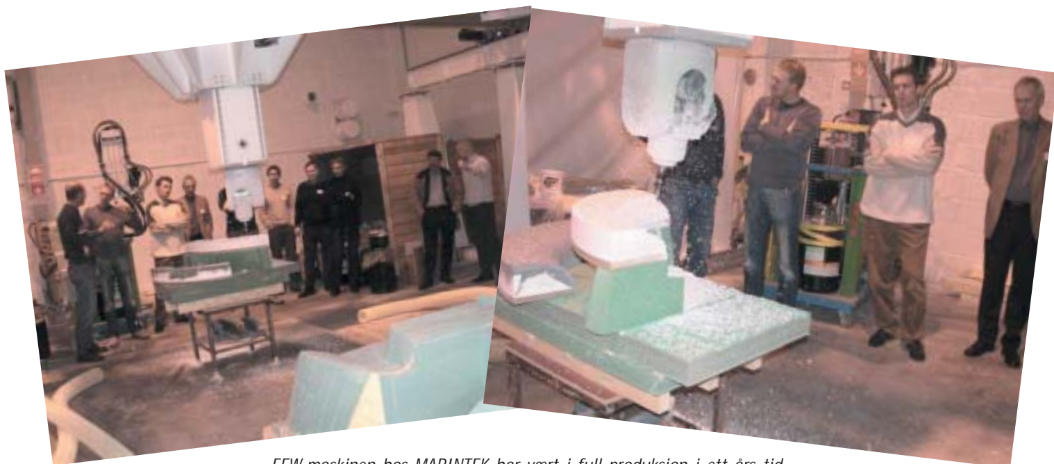
EEW-maskinen hos MARINTEK har vært i full produksjon i ett års tid. Styringen av fresespindelen har toleranser på \pm 1 promille og, avhengig av materialet, kan det oppnås matehastigheter på 200 meter i minuttet. Her demonstreres fresen for norsk båt- og komposittindustri.
